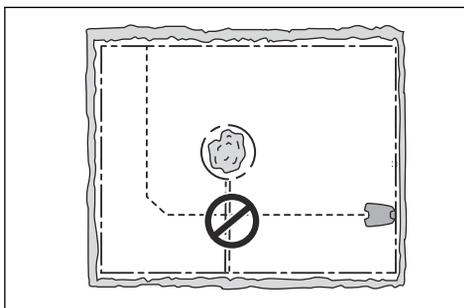
アイランドを作るには、境界ワイヤーで作業エリアの一部を隔離します。作業エリア内のすべての障害物を隔離することをお勧めします。
