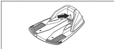
2. LED インジケータランプが緑色に点灯していない場合は、設置状態を確認します。チャージステーションのインジケータランプ 37 ページおよびチャージステーションを設置する方法 18 ページを参照してください。
