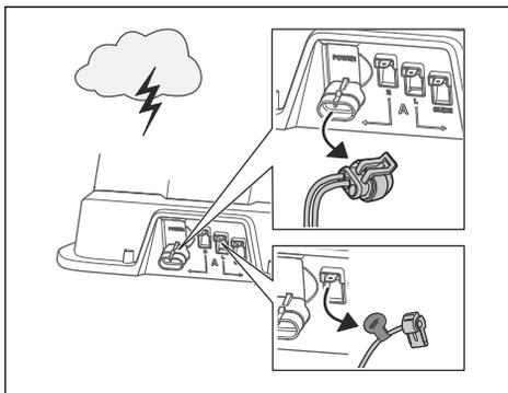
本製品およびチャージステーションの電気装置を損傷するリスクを減らすため、雷雨の危険がある場合は、チャージステーションのすべての接続（電源、境界ワイヤー、ガイドワイヤー）を外すことをお勧めします。
