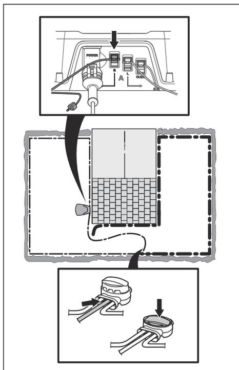
インジケータランプが黄色に点滅する場合、接続を外した箇所から新しいワイヤーを接続した地点の間 (下の図の黒い太線) のどこかでワイヤーが破損しています。この場合は、接続解除した端に新しいワイヤーを近づけて (破損が疑われるワイヤーセクションのほぼ中央まで)、インジケータランプが緑色になるか再度確認します。
