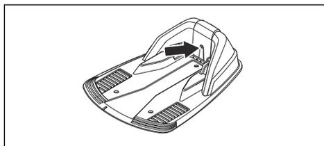
2. チャージステーションまでの境界ワイヤーが正しく接続されており、損傷していないことを確認します。チャージステーションのインジケータランプがまだ青色に点滅しているか確認してください。
