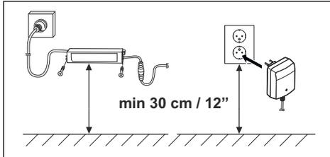
5. 電源装置を 100~240V の電源コンセントに接続します。
